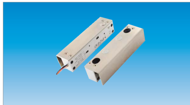
cod. 500500I Catenaccio dentro senza corrente per montaggio su porte in vetro. Dimensioni parte mobile: 148 x 37 x 24 mm Dimensioni parte fissa: 148 x 37 x 24 mm + 41 mm
