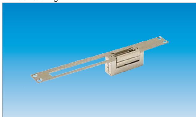
Cod. IE131NO - IE131NC Dimensioni: 250x31x39,5 mm Tenuta: 600 Kg
