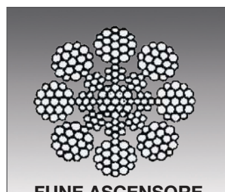
FUNE ASCENSORE GEARLESS 152 FILI 8 TREFOLI Resistenza 180 Kg N/mm 2
